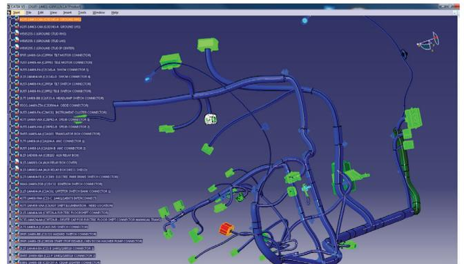
E<sup>3</sup>.3D Routing Bridge – Datenaustausch mit Mechanik CAD-Systemen.
